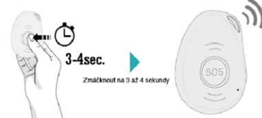
Pokud potřebujete pomoc, stisknete tlačítko SOS po dobu 3-4 sekund, dokud neucítíte vibrace zařízení a neuslyšíte pípnutí zařízení. Potom odejde ze zařízení požadavek na asistenci do našeho dohledového centra.
